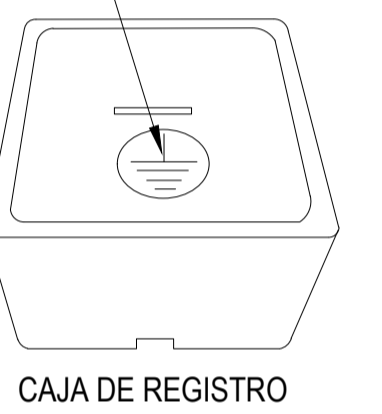
CAJA DE REGISTRO
