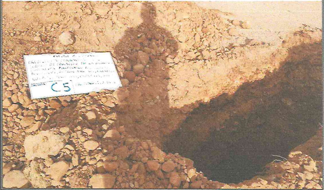
Fotografía N° 11: Vista de la CALICATA N°05 con datos del proyecto; donde se aprecia el material retirado de la exploración; con acercamiento a las paredes de la calicata, señalando parte de la estratigrafía correspondiente.
