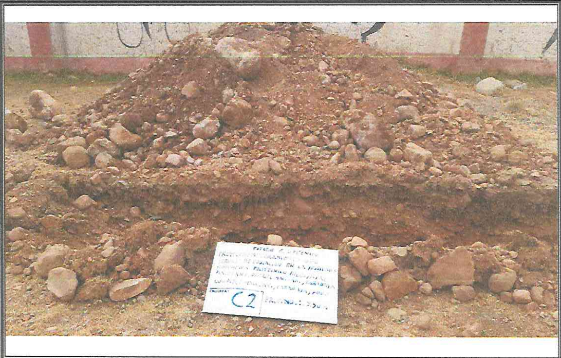
Fotografía N° 05: Vista de la CALICATA N°02 con datos del proyecto; donde se aprecia el material retirado de la exploración.
