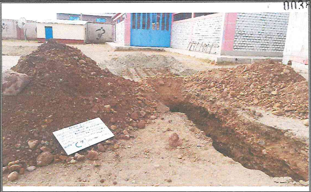
Fotografía N° 07: Vista de la CALICATA N°03 con datos del proyecto; donde se aprecia el material retirado de la exploración; con acercamiento a las paredes de la calicata, señalando parte de la estratigrafía correspondiente.
