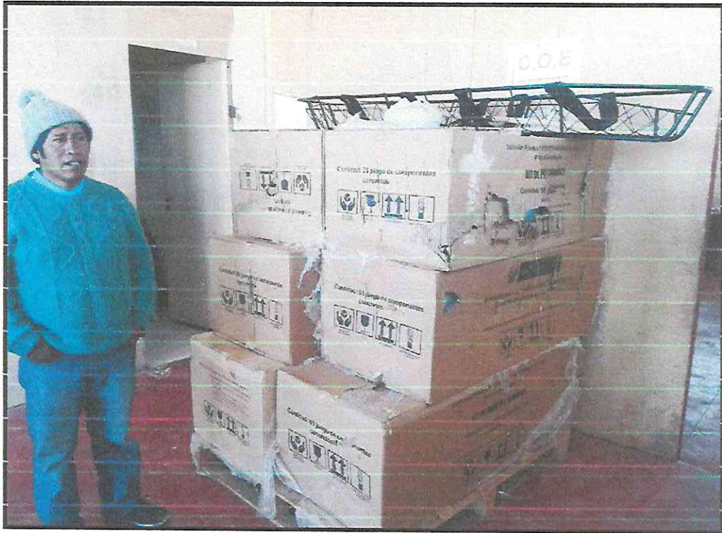
Figura 7. Acumulación de Objetos en la ruta principal de evacuación Fuente. Propia
