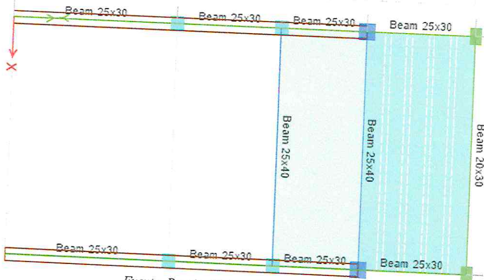
Figura 10: Planta techo - Bloque Escalera, modelado en el programa ETABS
