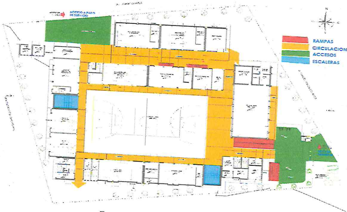
Figura 5: Diagrama: Primer nivel, accesos y circulación que contiene el proyecto
