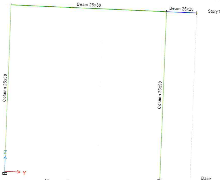
Fuente: Propia, Elaborado por el Equipo Técnico Figura 11: Vista 3D - Bloque Sub Estación, modelado en el programa ETABS
