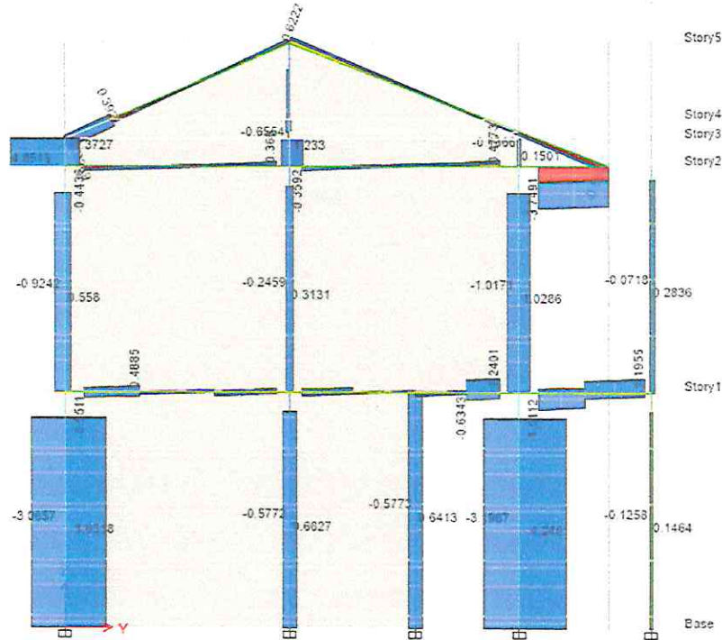
Figura 39: Diagrama de Momento Flector 3-3 Pórtico 14 - 14
