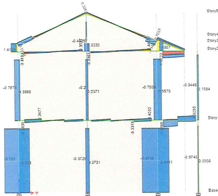
Figura 25: Diagrama de Fuerza Cortante 2-2 Pórtico I - I
