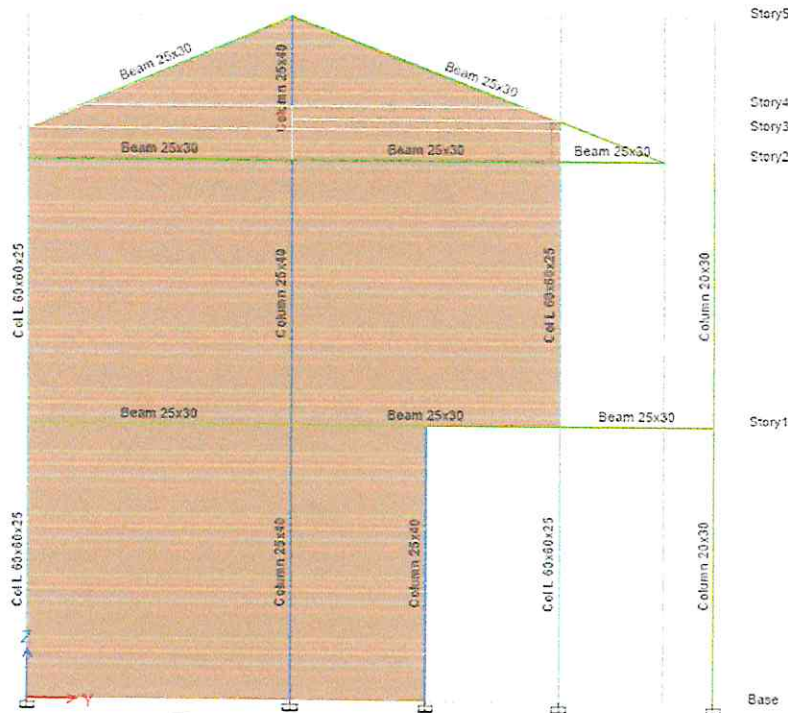
Figura 12: Elevación eje 15 - Bloque G en modelado en el programa ETABS
