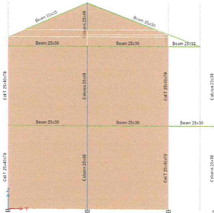
Figura 14: Elevación eje 3 - Bloque J en modelado en el programa ETABS
