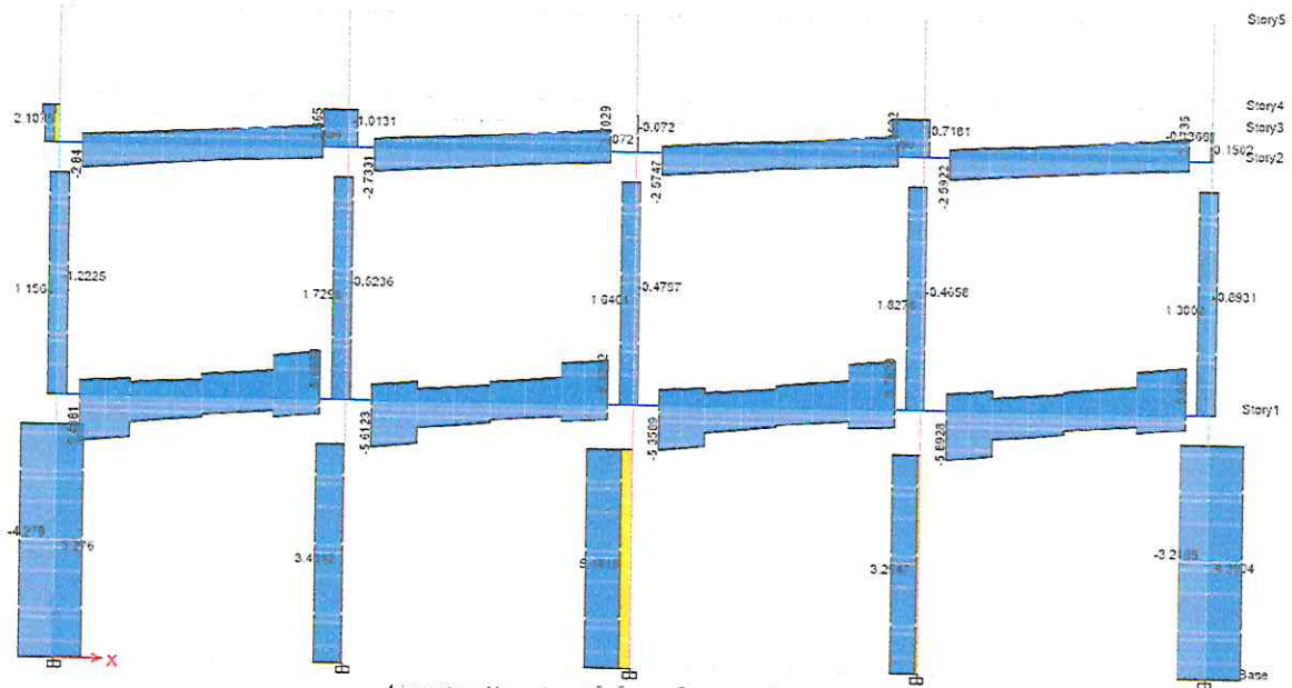
Figura 44: Diagrama de Fuerza Cortante 2-2 Pórtico H - H
