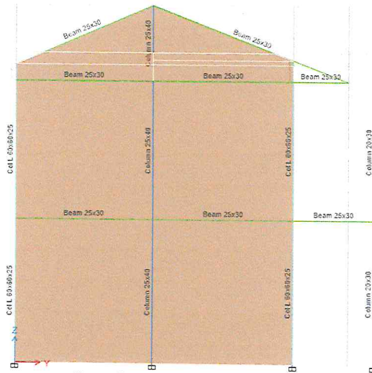
Figura 12: Elevación eje E y T - Bloque K en modelado en el programa ETABS
