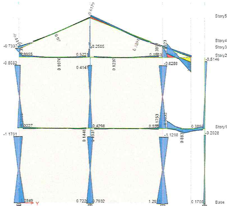
Figura 32: Diagrama de Momento Flector 3-3 Pórtico L - L
