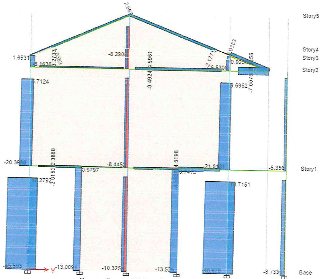
Figura 25: Diagrama de Fuerza Axial Pórtico 8 - 8
