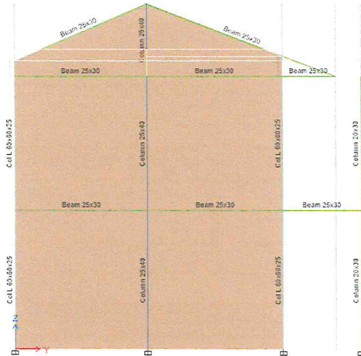
Figura 12: Elevación eje 1 y 5 - Bloque J en modelado en el programa ETABS
