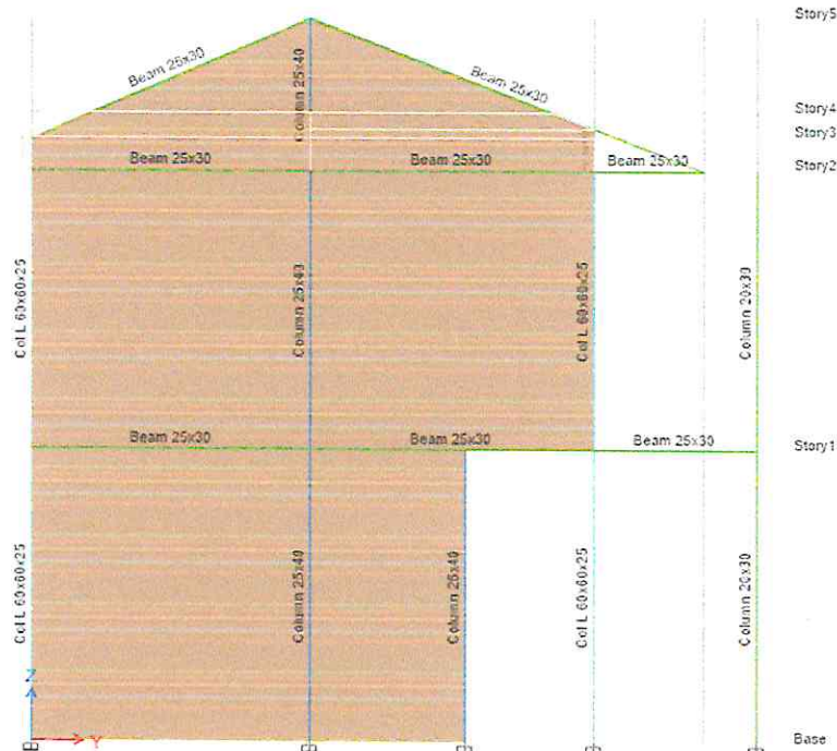
Figura 15: Elevación eje 14 - Bloque H en modelado en el programa ETABS
