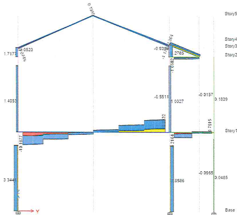
Figura 28: Diagrama de Fuerza Cortante 2-2 Pórtico K - K
