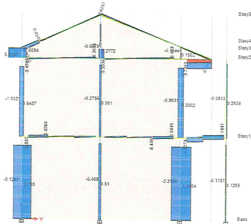
Figura 39: Diagrama de Momento Flexor 3-3 Pórtico 25 - 25
