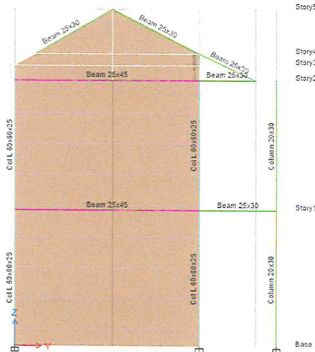
Figura 12: Elevación eje A y H – Bloque I, modelado en el programa ETABS
