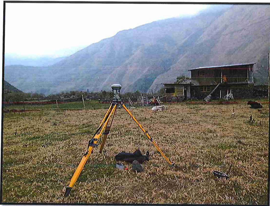
Figura 1: equipo GPS diferencial empleado para el levantamiento del eje de la vía.
